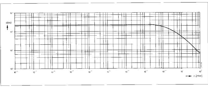
Fig. 32 Saugvermögen für Stickstoff  $N_2$ , TPH/TPU 240 Volume flow rate for nitrogen  $N_2$ , TPH/TPU 240 Débit-volume pour azote  $N_2$ , TPH/TPU 240
